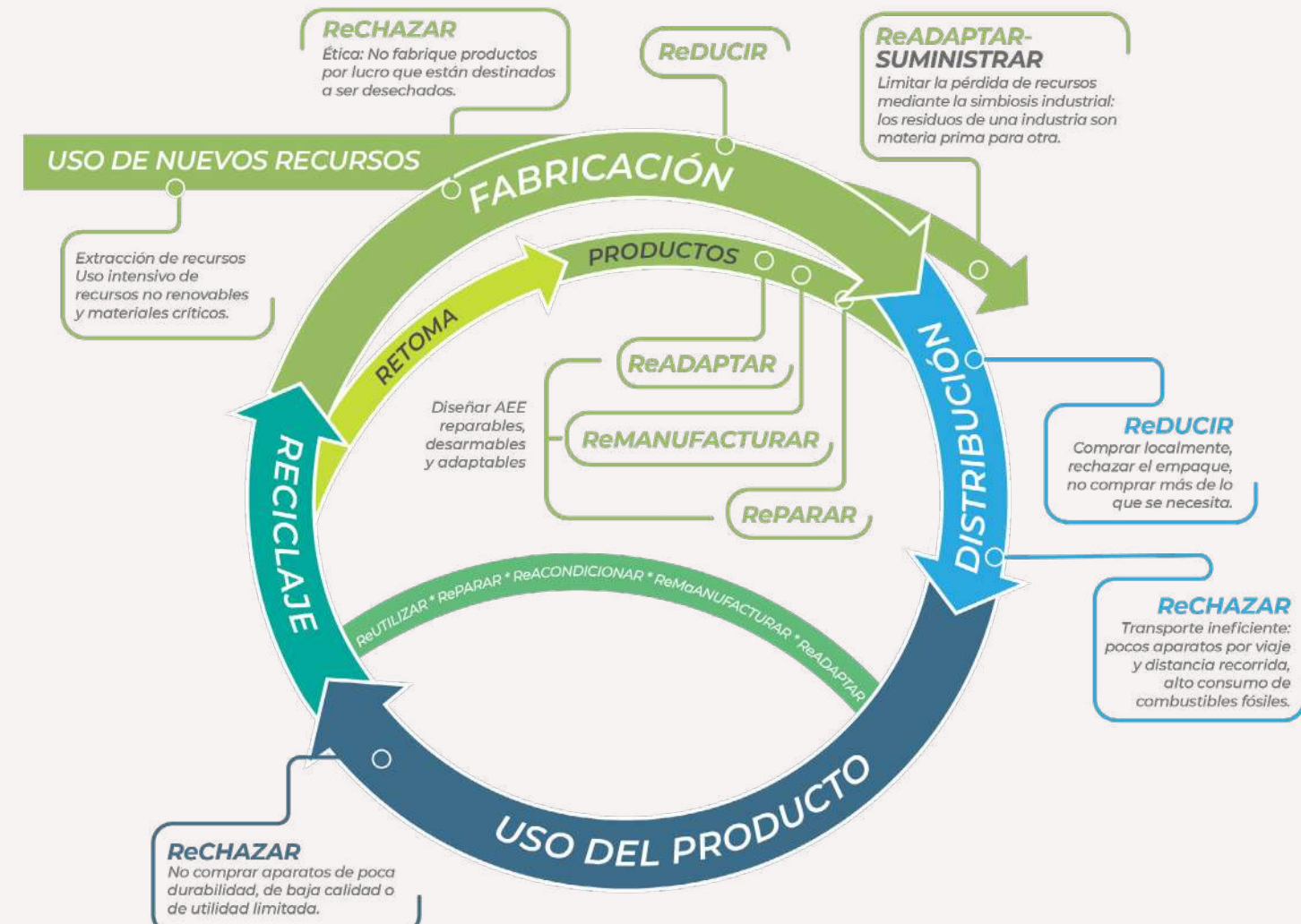
Figura 13. Economía circular y ciclos internos en la cadena de valor de los AEE-RAEE
