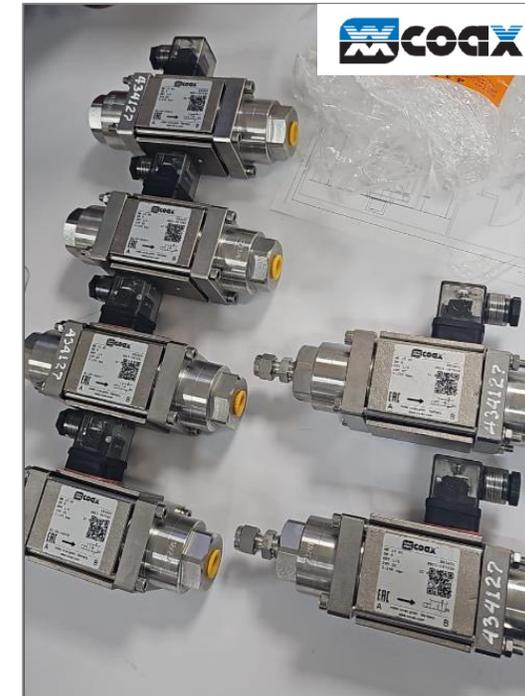
Válvula BPR en recalibración, actualmente abre 39 barg.
