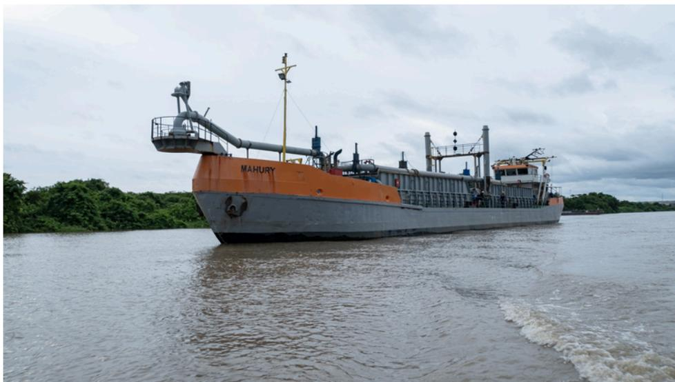
Las operaciones se realizan con una draga de succión en marcha, que hasta la fecha ha removido 180.000 m<sup>3</sup> de sedimentos, con un objetivo adicional de 90.000 m<sup>3</sup>. Las labores se ejecutan en ciclos de 2 a 4 horas, transportando el material extraído al área de vertido autorizada a 6 millas náuticas de la costa.
